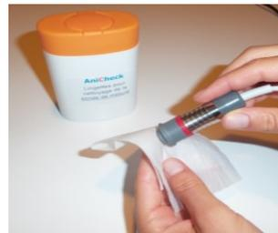
Reinigen Sie die Sonde mit einem feuchten Tuch oder einem trockenen Papiertuch. Verwenden Sie keinen Alkohol.
