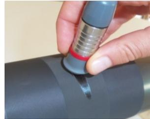
Führen Sie *drei* Messungen im Zentrierkreis mit Messflüssigkeit durchführen
